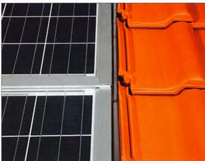
Durch einen speziellen Rahmen mit integrierten Bohrlöchern kann dieses Modul direkt auf die Dachlattung geschraubt werden. Dadurch liegt es tief im Dach, und der Montageaufwand ist gering. Rechts: Blick von innen
